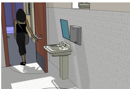
Imagem IV – Proposta de Adaptação de Sanitário na Procuradoria Geral do Estado , ampliação de passagem na abertura da porta, inclinação de espelho adequada.
