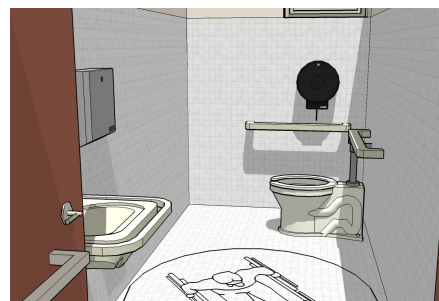
Imagem III – Proposta de Adaptação de Sanitário na Procuradoria Geral do Estado , instalação de barras de apoio e retirada de material de Limpeza.
